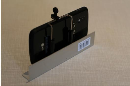
Abbildung 20: Smartphone-Stativ-Adapter
