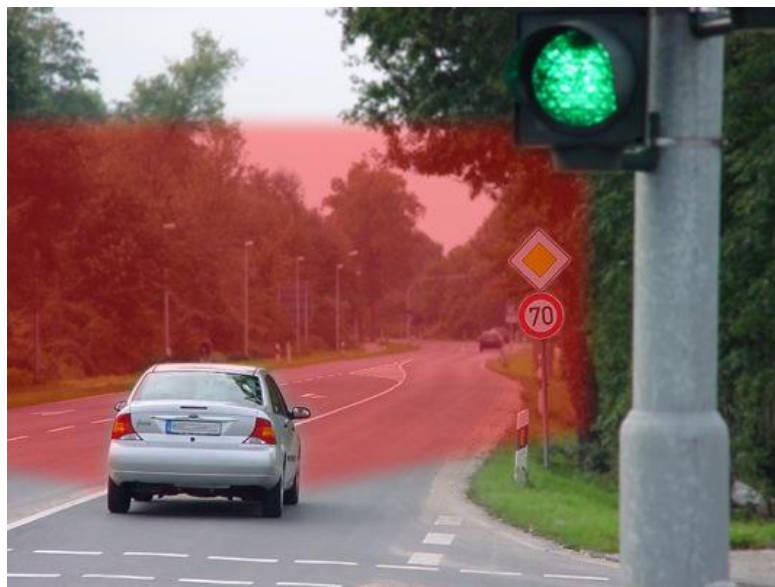
Abbildung 1-1: Kamerasichtfeld durch die Windschutzscheibe eines PKW. Das Sichtfeld wird rot dargestellt. [1]
