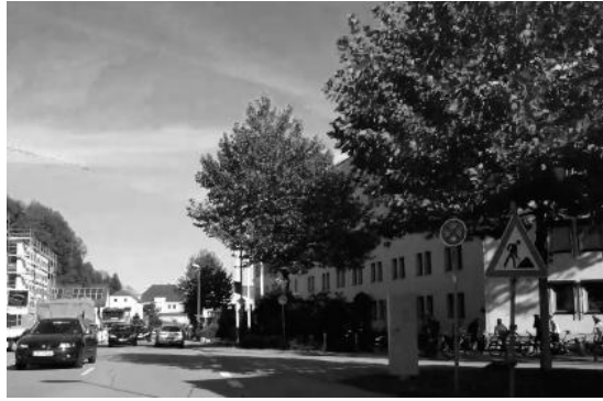
Abbildung 3-5: Umwandlung RGB Bild zu Graustufenbild durch Setzen des Sättigungswerts im HSV Bild auf S=0 .
