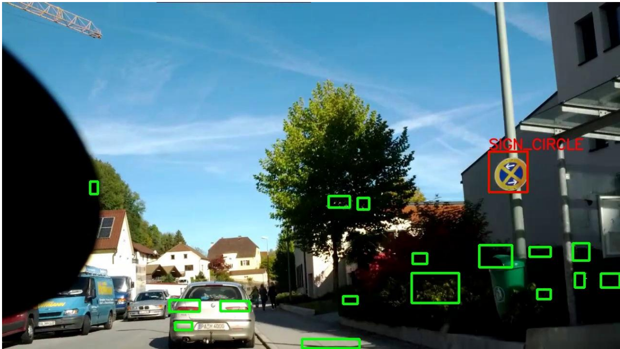
Abbildung 6-14: Durch Anpassung des Rotwertes im Filter, konnte auch ein sehr ausgebleichenes, rundes Schild erkannt werden.
