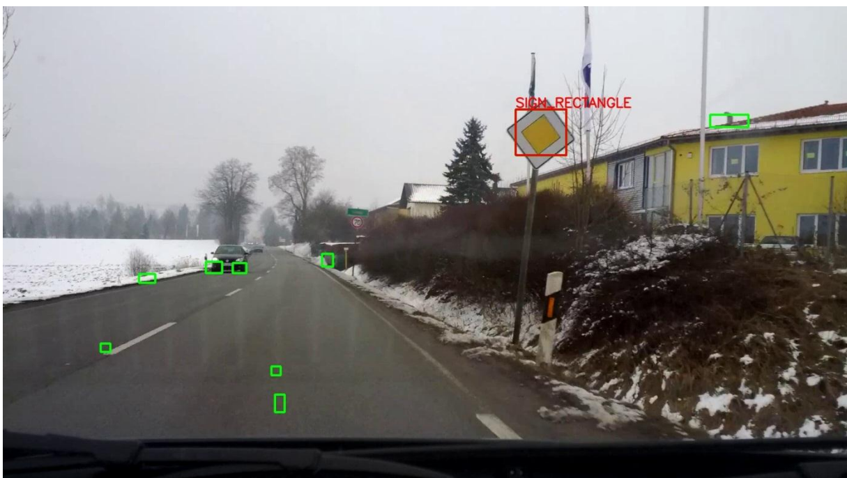
Abbildung 6-11: Erkennung eines viereckigen Schildes. Hier wurde kein Rotfilter gesetzt, darum wird das rote Schild nicht erkannt.
